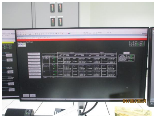
รูปที่ 3-7 การกำหนดค่าสัญญาณการแจ้งเตือน (Alarm) จากอุปกรณ์ CEMS
